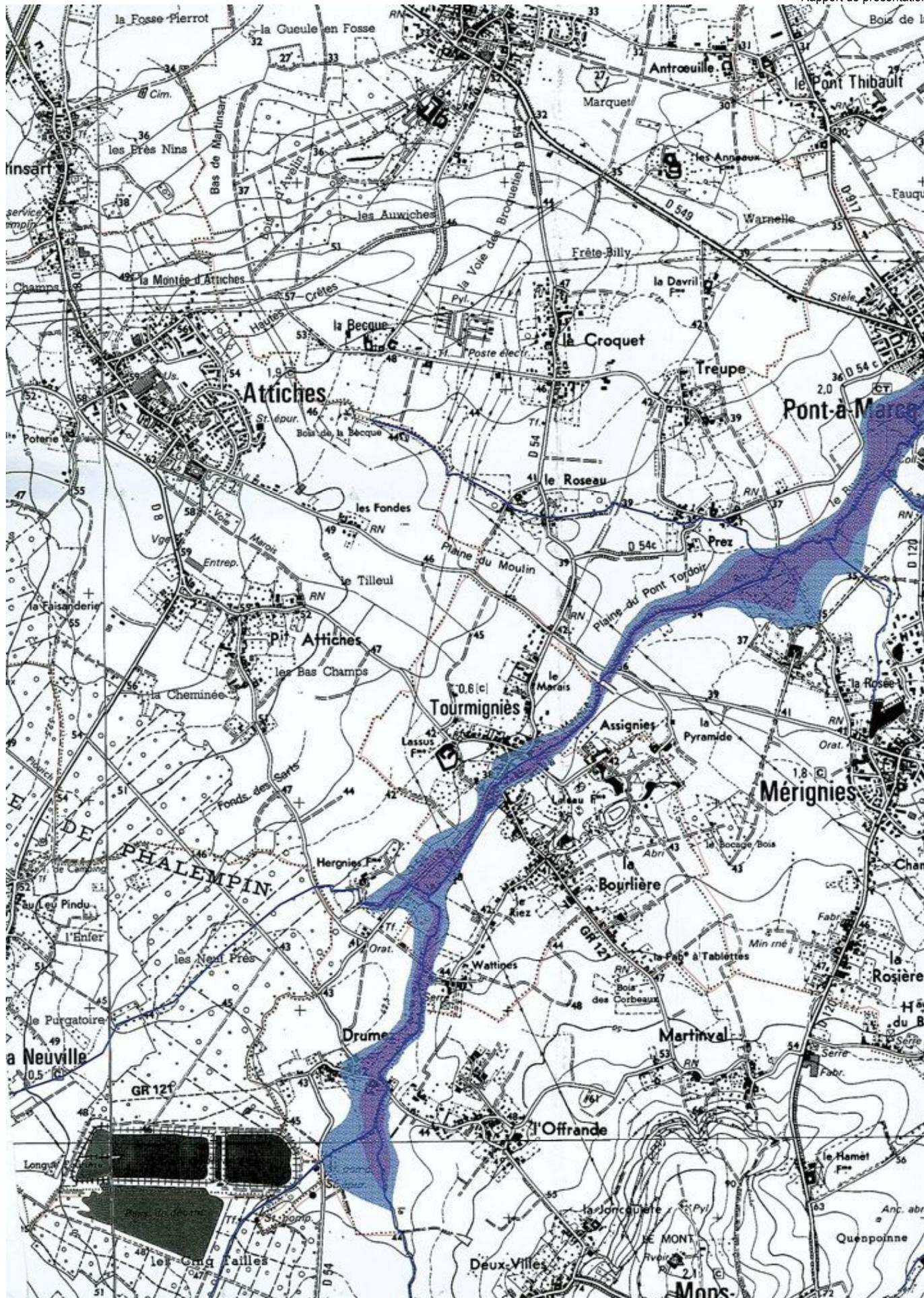
Cette étude a mené à la réalisation d'aménagements hydrauliques type barrage en terre, zone d'expansion de crue, curage et redimensionnement de ponts. Une zone d'expansion de crue est prévue au hameau de Drumez.
